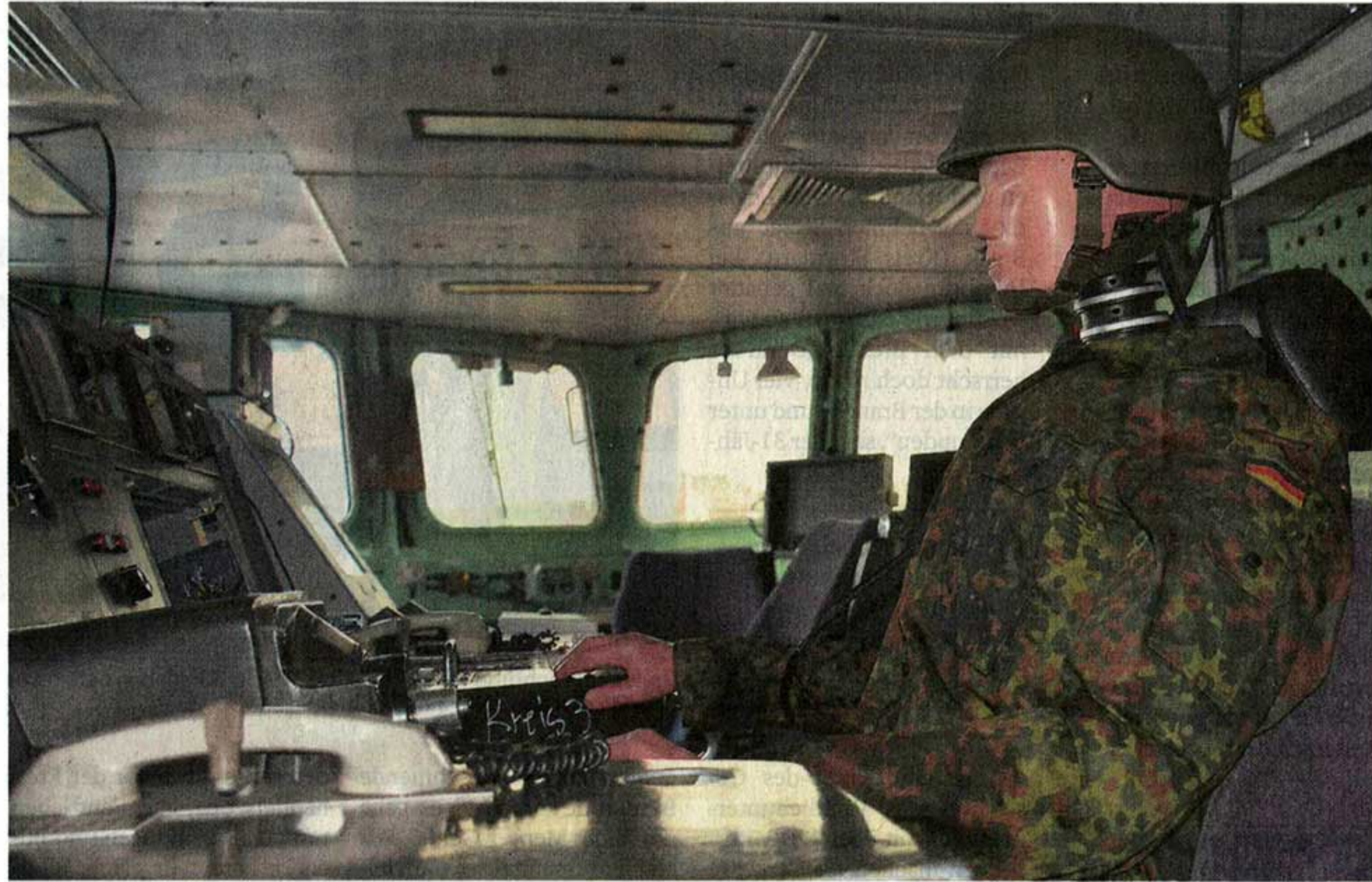
Testperson: Trifft die Schockwelle der Minenexplosion das Schiff, liefern die Dummy-Sensoren in Sekundenbruchteilen Daten. FOTO: SCHULZ
